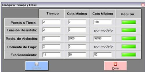
This screenshot shows the 'Configurar Tiempo y Cotas' window, which allows users to set test parameters. It includes a table with columns: 'Tiempo', 'Cota Mínima', 'Cota Máxima', and 'Realizar'. The parameters are: 'Puesta a Tierra' (2, 0, 150), 'Tensión Resistida' (2, 0, por modelo), 'Resis. de Aislación' (2, 2000, 99999), 'Corriente de Fuga' (2, 0, por modelo), and 'Funcionamiento' (11, 50, 50). A 'Centar' button is at the bottom.
